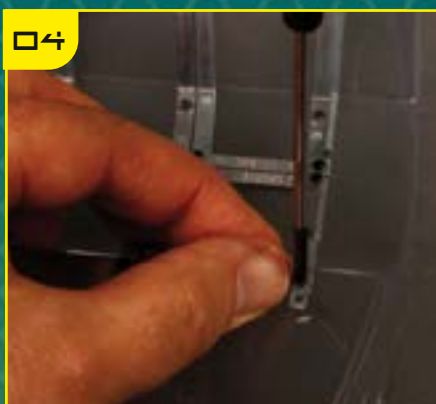
04 Зафиксируйте накладку с помощью крепежного винта.
